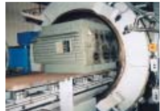
VTR装置 ：子会社ゼロ・ジャパン(株)はVTR(真空加熱処理技術)を用いて有害廃棄物PCBを分離処理する高度な技術を保有しています。現在、環境事業団によるPCB処理関連施設計画が進められており、その第1号としての北九州プロジェクトに、同社のVTR装置が納入されます。
